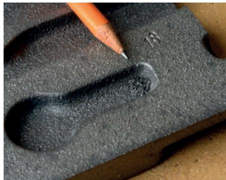
**Bild 382:** Sekundärpenetrationen können auch an kleinen Gussstücken auftreten, sind stets an heißen Kanten und bevorzugt Ecken zu finden...
