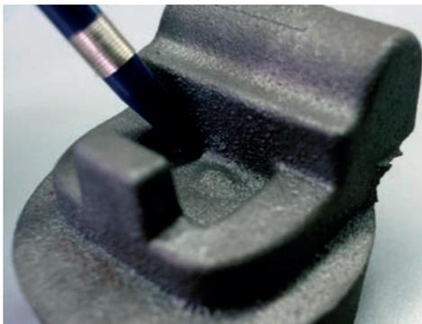
**Bild 381:** Noch verdeckte Sekundärpenetration, d. h. getriebener Guss, aber aufgrund der Lage sicher nicht wegen mangelhafter Formverdichtung, sondern bedingt durch den Grafitisierungsdruck, der eine am heißen Innenballen bis zum Entstehen des Fehlers nur unzureichend erstarrte und daher noch nachgiebige Gusshaut aufgewölbt hat
